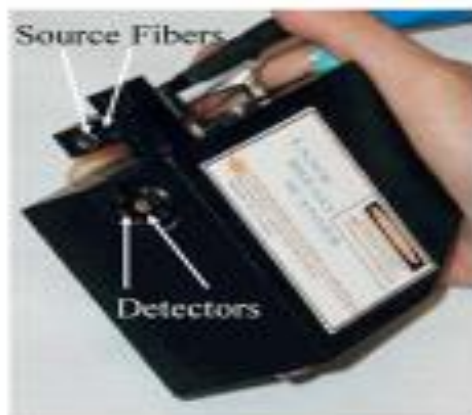
شکل ۲۲. پروب دستگاه اسپکتروسکوپی اپتیکی برای اندازه گیری غلظت فاکتورهای خونی پستان (۳)
